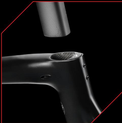
従来のシートクランプに変わって採用されたフレームと一体化されたTwinForce™シートクランプは、エアロダイナミクス特性を向上させフレームとシートポストの継ぎ目をシームレスにします。
