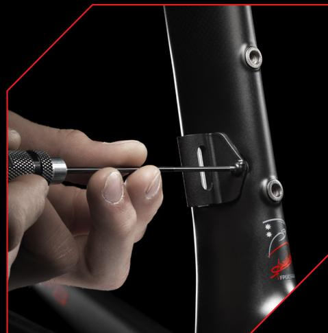
タイムトライアル等で使用する場合などに、フロントディレイラーの台座が不要になれば取外してエアロダイナミクスを改善させる事ができます。
