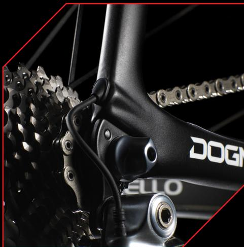
リアディレイラーのケーブル/ワイヤーは、さらなるエアロダイナミクスを追求し、ドロップアウトの後方に出口が設けられました。
