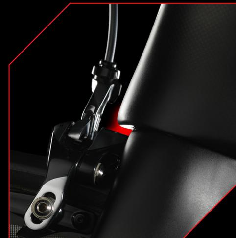
新しいエアロヘッドチューブは、フロントブレーキの周囲に発生する気流を整えるようデザインされています。
