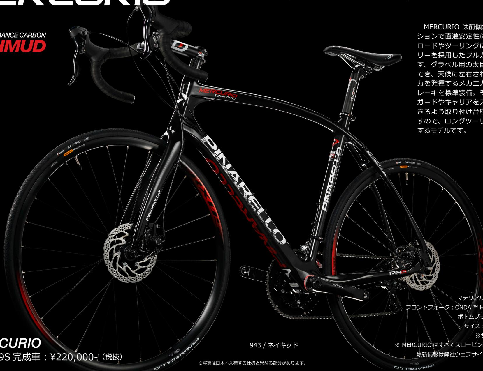
MERCURIO は前傾がきつくないポジションで直進安定性に優れ、グラベルロードやツーリングに適したジオメトリーを採用したフルカーボンモデルです。グラベル用の太目のタイヤが装着でき、天候に左右されず安定した制動力を発揮するメカニカル・ディスクブレーキを標準装備。そしてフルマッドガードやキャリアをスマートに装着できるように取り付け台座も装備していますので、ロングツーリングにもお勧めするモデルです。
